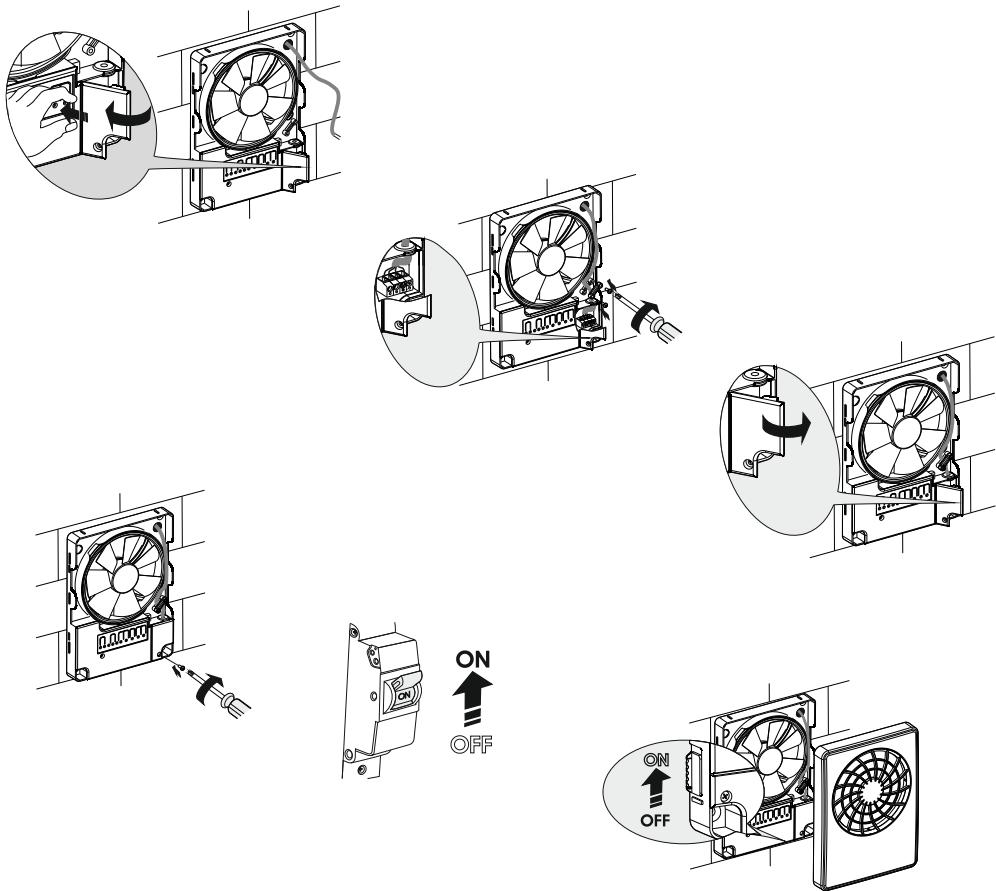
Il ventilatore è concepito per l'allacciamento alla rete di corrente alternata monofase da 100-240 V / 50- 60 Hz. Il ventilatore ha quattro opzioni di raccordo. Il modello iFan move è dotato di una morsetta LI supplementare per il raccordo a una lampadina fino a 200 W / 230 V (o 100 W / 120 V). La lampadina si accende non appena riceve un segnale dal rilevatore di movimenti.
