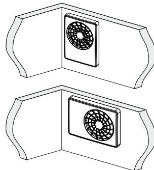
Il ventilatore è idoneo per il montaggio sopra muro e per il raccordo a condutture da 100 o 125 mm di diametro oppure per l'installazione a una grata di aerazione
