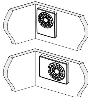
L'aérateur peut être monté au mur (en saillie) sur des tuyaux de 100 ou 125 mm de diamètre ou sur un conduit d'aération.
