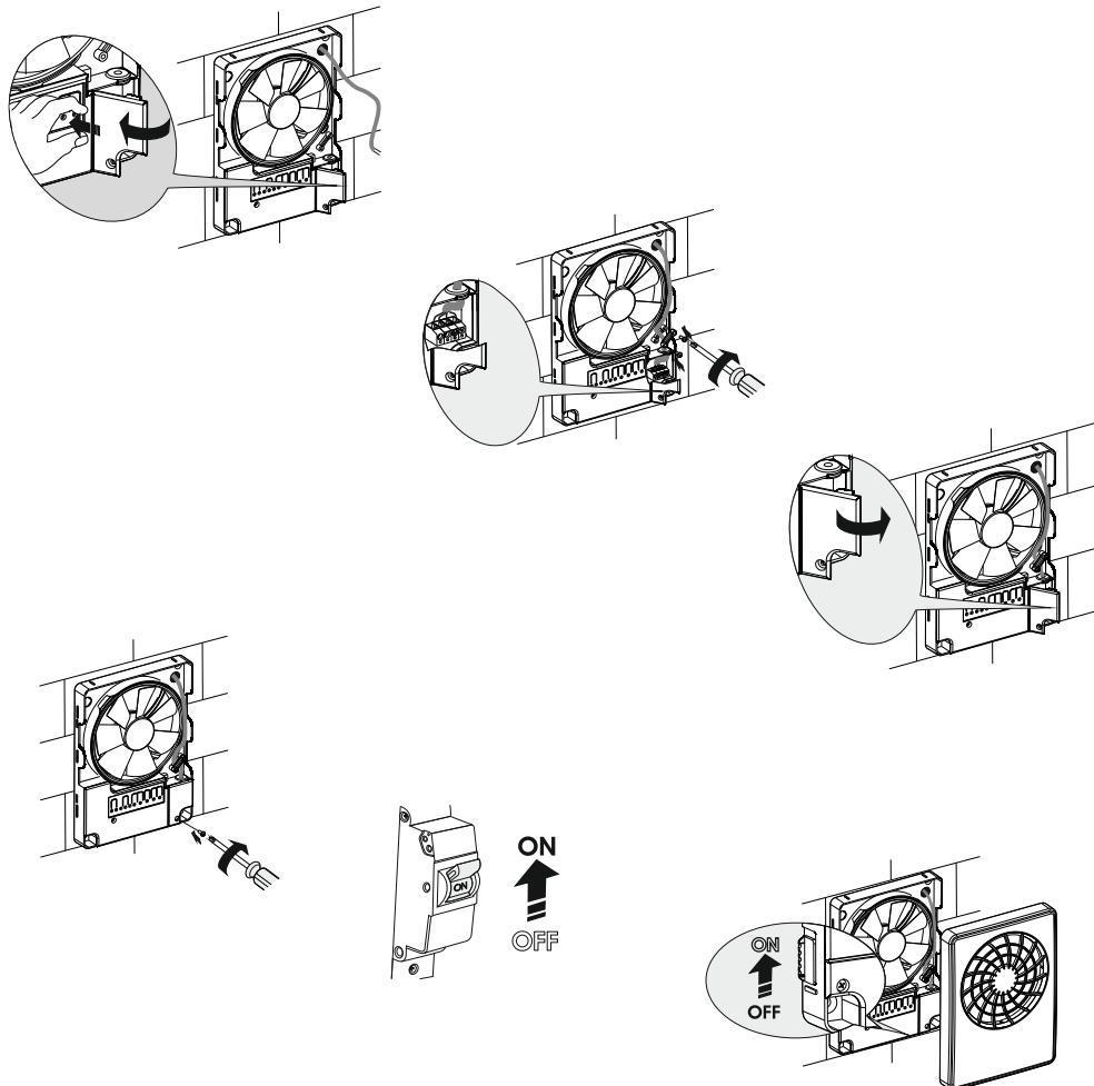
L'aérateur est conçu pour être raccordé à un réseau alternatif monophasé de 100-240 V / 50-60 Hz. Il existe 4 possibilités de branchement. Le modèle iFan Move possède une borne supplémentaire (LI) pour le branchement d'une ampoule de 100 W / 120 V à 200 W / 230 V max. Cette dernière s'allume dès que le détecteur de mouvement envoie un signal à la borne.
