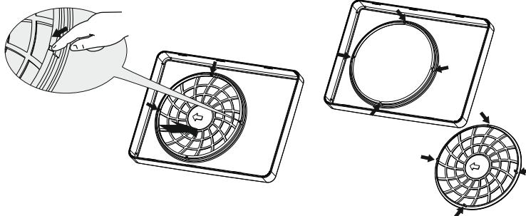
Der Lüfter ist mit einem abnehmbaren Gitter ausgestattet.
