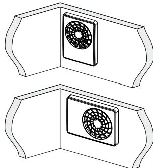
Der Lüfter eignet sich für die Wand-Aufputzmontage und Anschluss an Ø 100 oder Ø 125 mm Rohrleitungen oder für die Installation an einen Lüftungsschacht.
