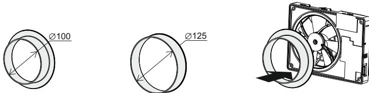
Der austauschbare Anschlussstutzen von verlangter Größe kann zur leichteren Montage verwendet werden.
