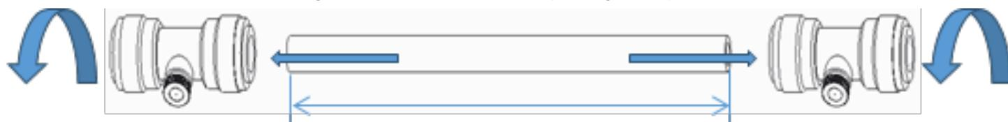
5. Inserire il tubo flessibile ruotando un po' il tappo. Il tubo flessibile deve essere inserito almeno 10 mm o fino a raggiungere il raccordo. Tirare il tubo flessibile per verificare che sia saldamente inserito nel raccordo.
