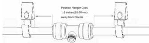
Achten Sie darauf, dass der Schlauch während der Installation straff gespannt wird, um ein Durchhängen zu verhindern. Falls erforderlich, richten Sie die Düsen sorgfältig aus, so dass alle in die gleiche Richtung zeigen.
