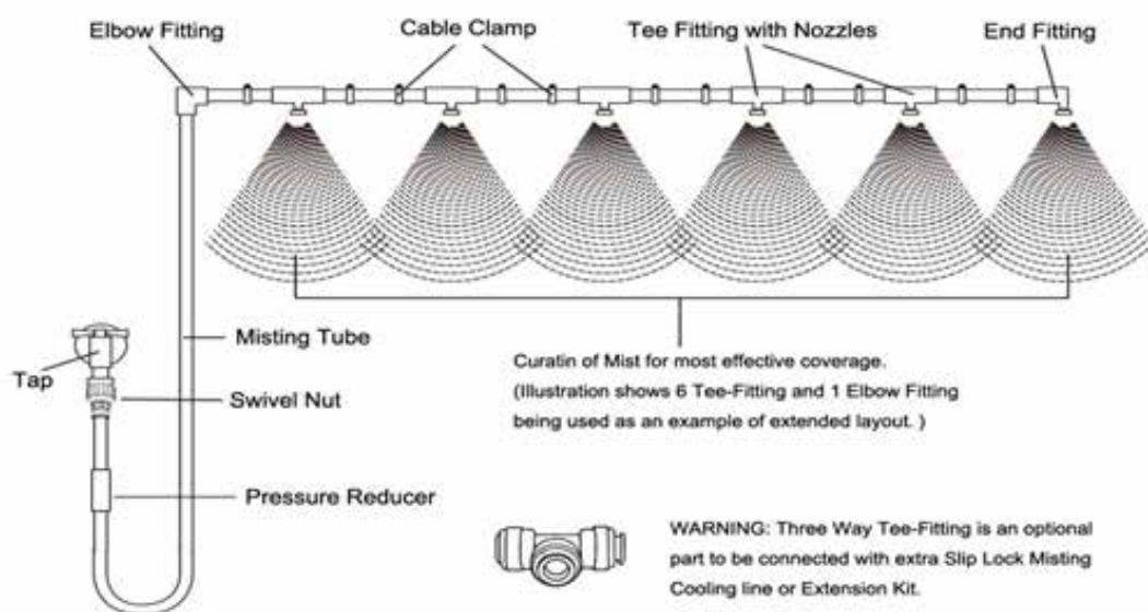
Placez un des supports de suspension ou des colliers de serrage fournis sur la ligne de brouillard à environ 25-50 mm à gauche et à droite de chaque buse (sauf le dernier raccord de buse).
