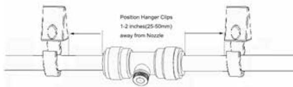
Veillez à ce que le tuyau soit bien tendu lors de l'installation pour éviter qu'il ne s'affaisse. Si nécessaire, alignez les buses avec soin de manière à ce qu'elles soient toutes orientées dans la même direction.
