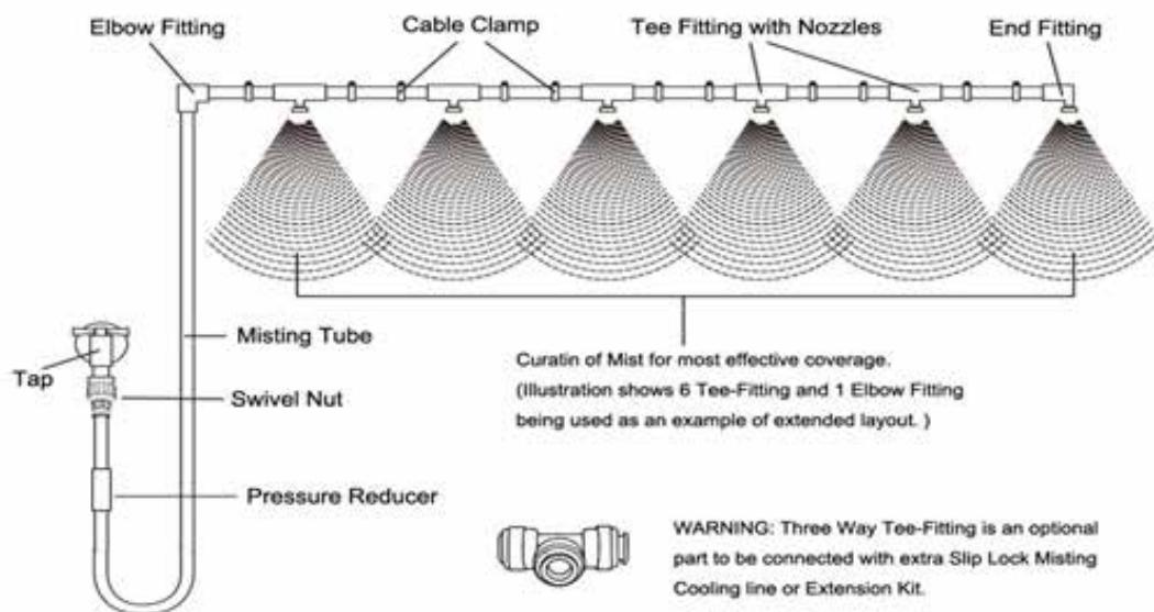
Platzieren Sie die mitgelieferten Aufhängeklammern oder Schlauchschellen über die Nebelleitung, etwa 25-50 mm links und rechts von jeder Düse (mit Ausnahme des letzten Düsenanschlusses).
