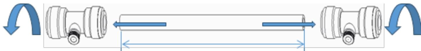
5. Insérez le tuyau tout en tournant un peu le bouchon. Le tuyau doit être inséré d'au moins 10 mm ou aussi loin qu'il ira dans le raccord. Tirez sur le tuyau pour vérifier qu'il est serti dans le raccord.
