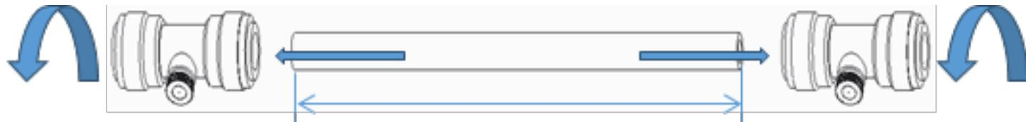
5. Schieben Sie den Schlauch ein, während Sie den Verschluss ein wenig drehen. Der Schlauch sollte mindestens 10 mm oder bis zum Anschlag in die Verschraubung eingeführt werden. Ziehen Sie am Schlauch, um zu prüfen, ob dieser fest im Verbindungsstück sitzt.
