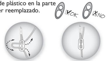
1 - Hacer deslizar la cuerda en el anillo. 2 - El bloqueo de la altura se realiza automáticamente una vez ajustada la medida.
