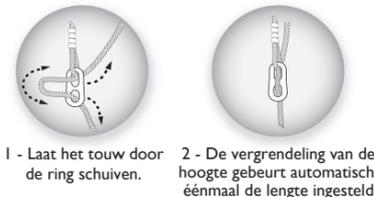
1 - Laat het touw door de ring schuiven. 2 - De vergrendeling van de hoogte gebeurt automatisch, éénmaal de lengte ingesteld
