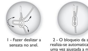
1 - Fazer deslizar a sensata no anel. 2 - O bloqueio da altura realiza-se automaticamente uma vez ajustada a medida.
