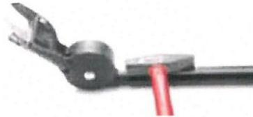
**2. Klopfen Sie leicht, mit einem Hammer, von unten gegen den Kopf, um den Schneidkopf aus dem Aluminium-Rohr zu lösen.**
