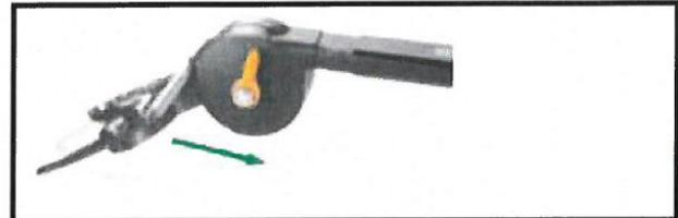
**10. Ziehen Sie das Band und das Zugstück in das Rohr und führen Sie den Schneidkopf wieder ein. Pressen Sie den Kopf wieder ein.**
