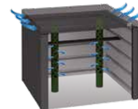
Die integrierten Belüftungsrohre sorgen für eine optimale Sauerstoffzufuhr und Luftzirkulation, womit eine effiziente Kompostierung gewährleistet ist.
