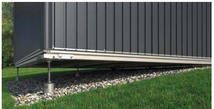
Mit den Standard-Erdschrauben können Bodenunebenheiten und Hangneigungen bis zu 10 % Gefälle ausgeglichen werden. Für grössere Höhenunterschiede sind Verlängerungen auf Anfrage erhältlich.
